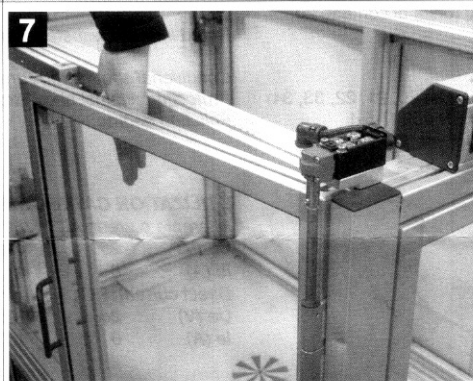
Verificar o ponto de operação conforme EN 294. Ajustá-lo novamente se necessário (ver Fig. 6). Verify the operating point according to EN 294, adjust the operating point again if necessary (see fig. 6).
