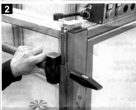
Travamento da dobradiça. Hinge locking.
